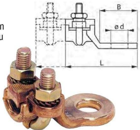
Les cosses et raccords à serrage par bride sont en laiton matricé et livrés, équipés d'étriers acier 60 Kg zingué ou équipés d'étriers bronze (dans ce cas, la référence est suivie de la lettre "B")
