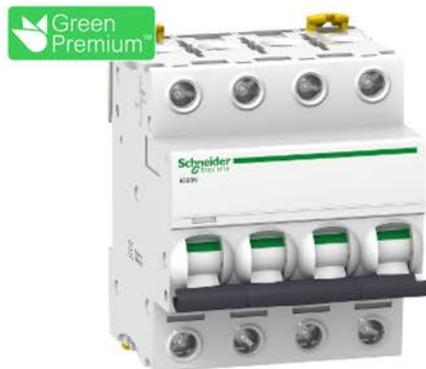
Disjoncteur, Acti9 iC60N, 4P, 40 A, courbe C, 6000 A (IEC 60898-1), 10 kA (IEC 60947-2)
