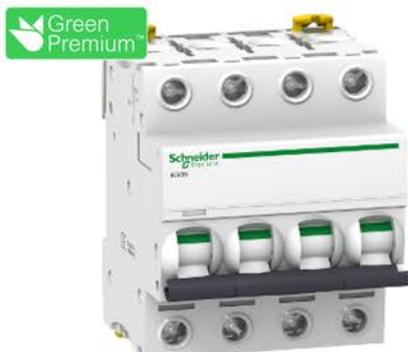
Disjoncteur, Acti9 iC60N, 4P, 25 A, courbe C, 6000 A (IEC 60898-1), 10 kA (IEC 60947-2)
